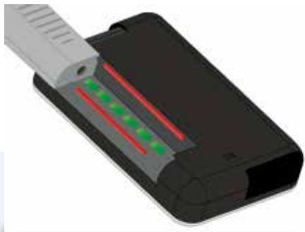
Befülltes Reservoir mithilfe der Führungsschienen in die t:slim X2 einsetzen, bis ein Klicken zu hören ist.
